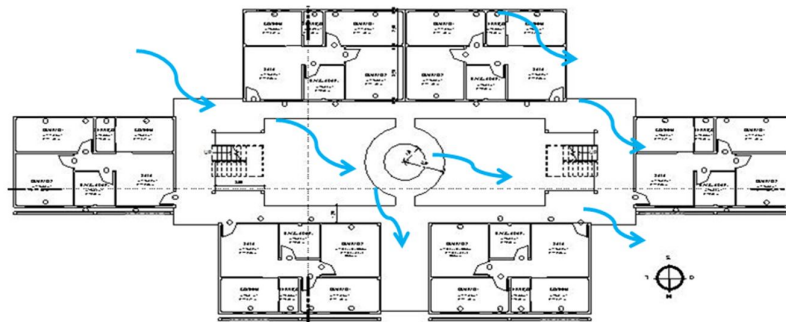
Figura 24. Esquema da passagem dos ventos dentro do edifício.
