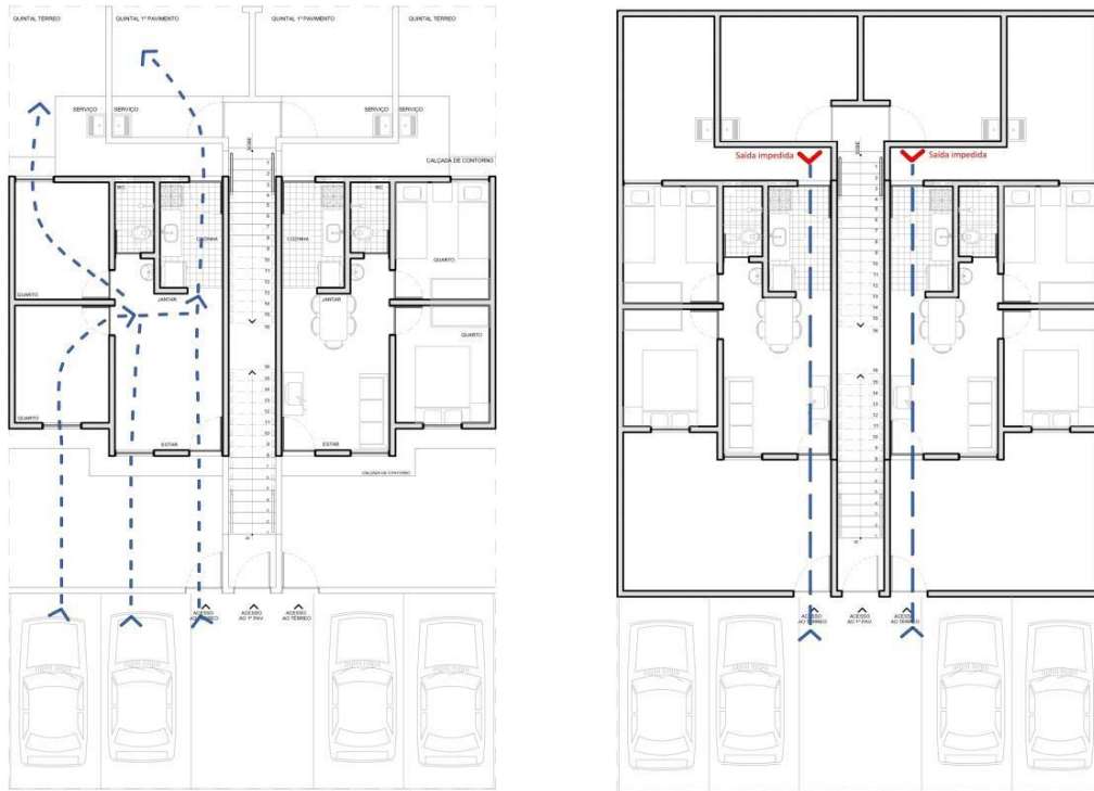
Figuras 15 e 16: Sistema de circulação de ar em unidade original e reformada com a elevação dos muros posteriores e frontais, dificultando a saída (circulação) do ar.
