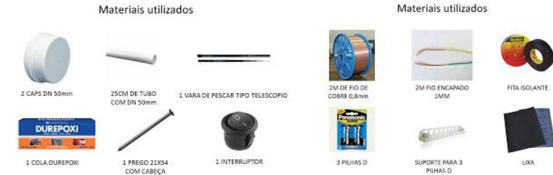
1º passo: Enrolar o fio de cobre no prego indo e voltando pelo menos duas vezes e deixando sobrar no mínimo 20cm nas pontas, para ser ligado no suporte das pilhas.
