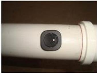
9º passo: Colar a vara no CAP com cola DUREPOXI.
