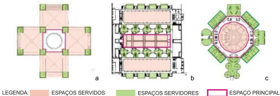
Figura 7: Espaços servidos e servidores sobre plantas-baixas. a) Casa de Banho da Comunidade Judaica de Trenton. b) Instituto Salk. c) Prédio da Assembléia de Dacca. Fonte: Desenho dos autores sobre imagens disponíveis em: <www.greatbuildings.com>. Acessos em 06 set. 2011.
