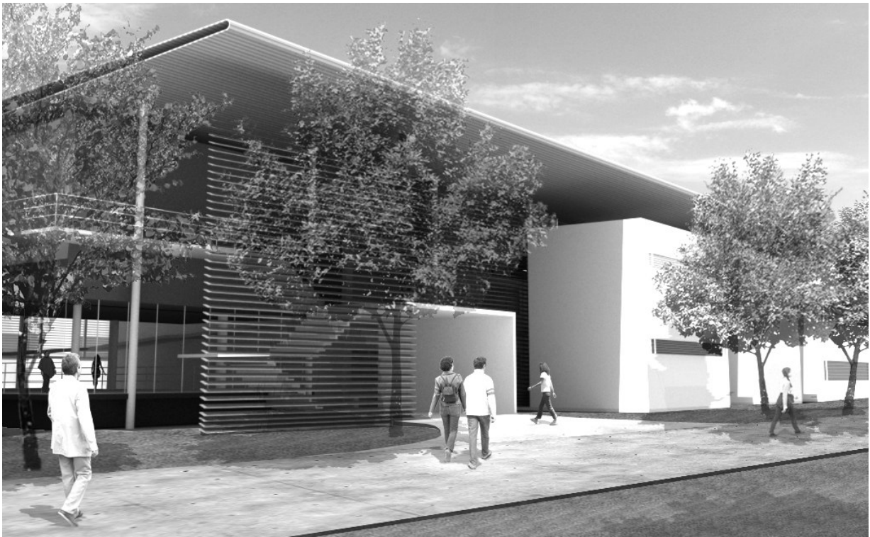
Figura 03: Perspectiva externa do projeto para o Instituto de Bioquímica Médica da UFRJ mostrando dispositivos de controle energético passivo integrados à concepção arquitetônica do edifício. Fonte: Arquilab / Atelier Universitario, FAU/UFRJ.
