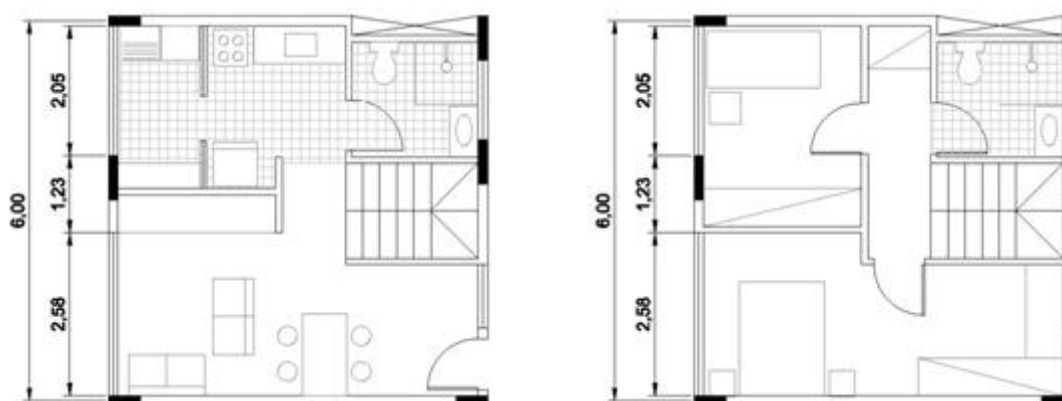
Figura 13: 2 módulos unidos verticalmente (duplex) totalizando 72m 2 e 2 dormitórios. Fonte: Autoras Nov. 2010.
