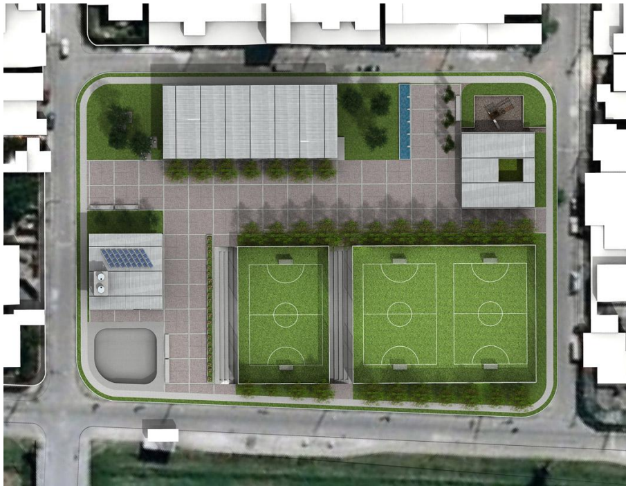
Figura 04: Edson Mahfuz, Centro de Liderança para Mulheres e Jovens, Santa Cruz, Rio de Janeiro, 2010. A posição dos pavilhões define a vinculação entre eles, a tridimensionalidade do espaço público e o caminho diagonal através do terreno. Fonte: Edson Mahfuz.
