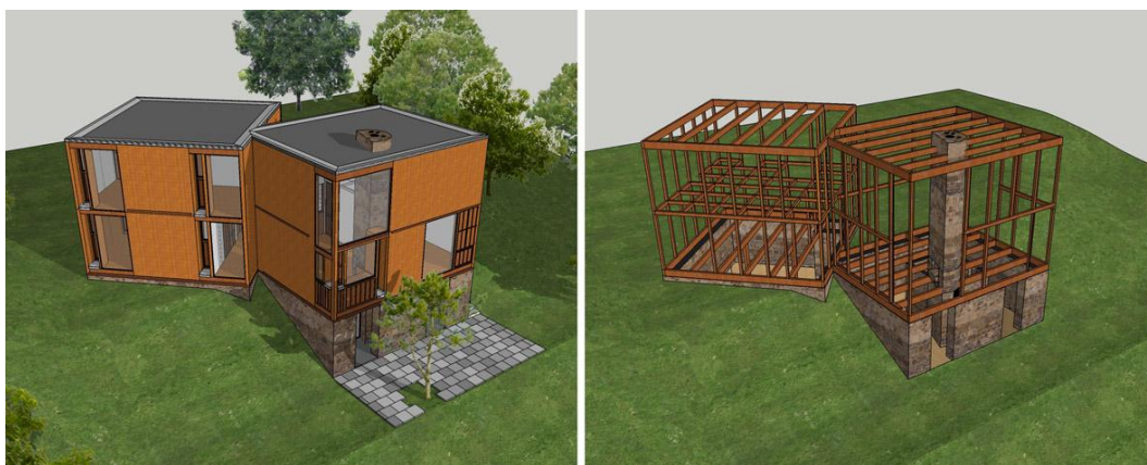
Figura 02: (Re)construção da Casa Fisher, Louis Kahn, Hatboro, Pennsylvania, EUA.
