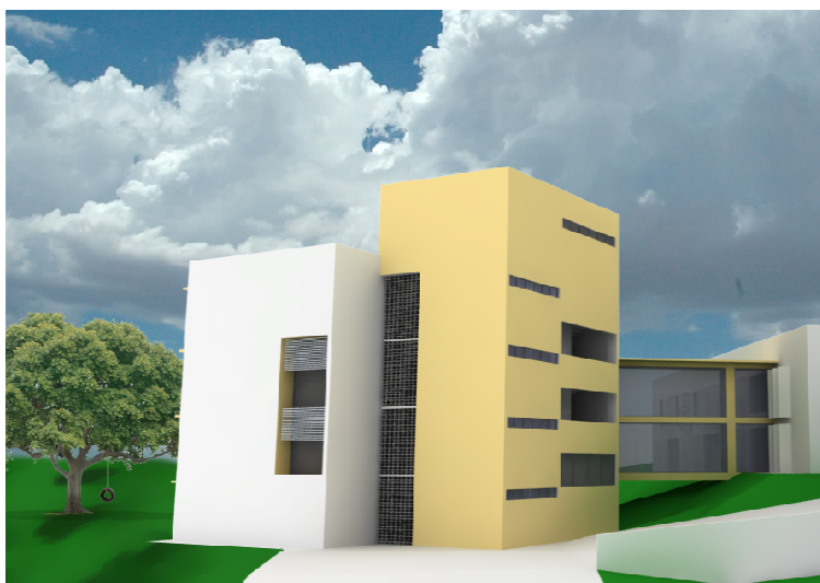
Figura 9 – Unificação das janelas do bloco secundário e aberturas das escadas, em uma primeira alteração, vista em perspectiva.
