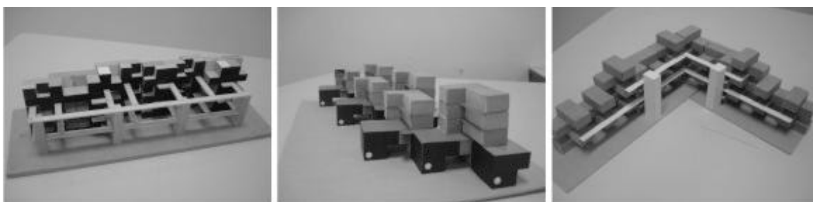
FIG. 09 | Os estudos de circulação nos agrupamentos verticais foram elaborados posteriormente à concepção da volumetria e promoveram algumas alterações na mesma.
