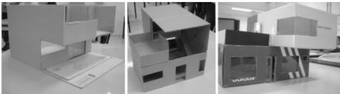
Fig. 02 | Unidades sobrepostas ilustram as regras de composição volumétrica: a UH da esquerda gera uma área coberta na parte inferior sem fechamento. A UH do centro apropria-se de da laje de cobertura do piso inferior como área aberta de convívio (privativa) e a UH à direita serve-se das duas condições descritas.
