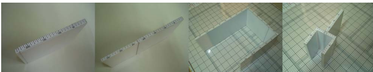
Foto 1 – O sistema retrátil para as paredes utilizado no modelo (Fonte: foto do autor).
