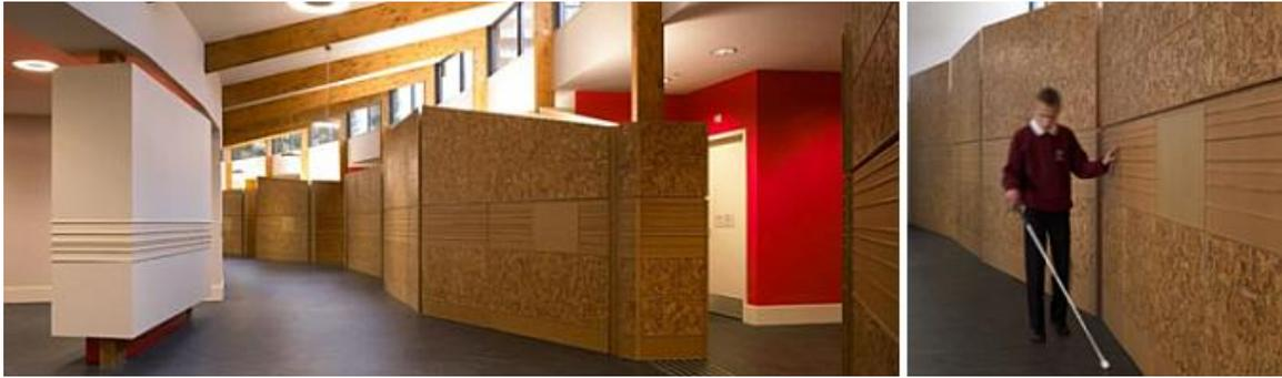
Fig. 05– O material de revestimento contribuindo na percepção do espaço. O movimento da superfície evita a formação de ecos no local.
