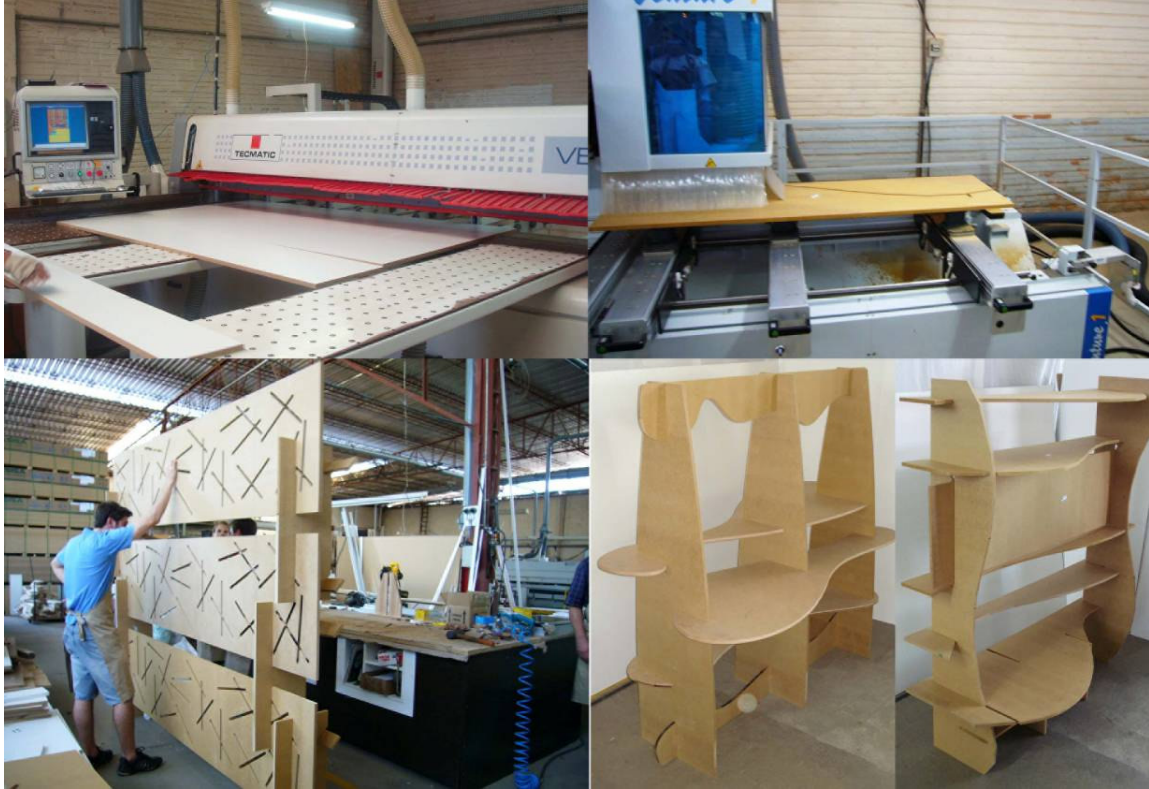
Fig.6. Corte y Montaje de Muros-mueble en Workshop (autores)
