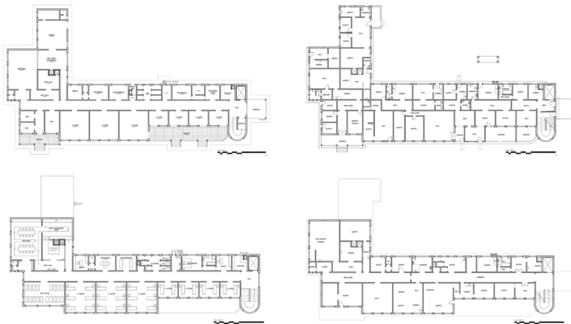
Figura 2 - Comparativo entre a compartimentação original (coluna esquerda) e o levantamento (direita). A linha superior refere-se ao primeiro pavimento e a linha inferior ao segundo. Fonte: Arquivo CJM.
