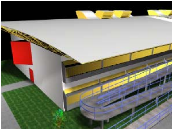
Figura 19. Captadores de vento acoplado à cobertura e à lateral do edifício. Fonte: Arquivo do autor.
