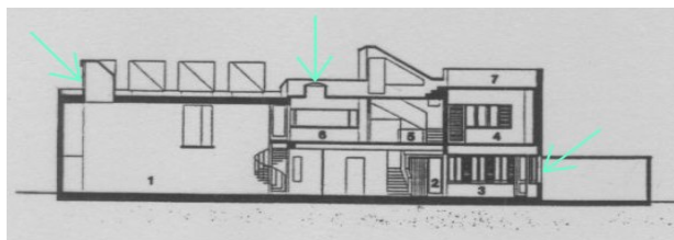
Fig. 07 – Corte Longitudinal – Iluminação Natural
