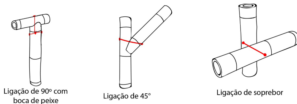
..... FIGURA 2 Ligações com barras roscadas (2021).
