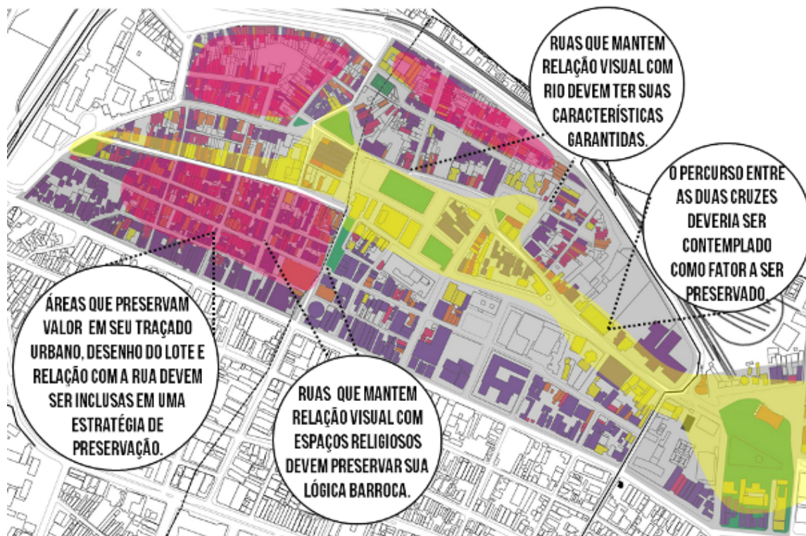
Figura 11 – Análise de parte do Centro Histórico com destaque para aspectos relevantes para a construção da Norma de Preservação da área. Fonte: Produção dos autores.
