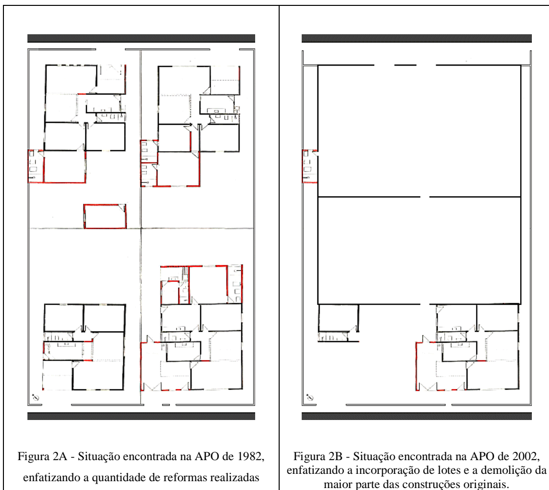
FIGURA 2 - Planta Baixa Esquemática de um conjunto de 4 unidades habitacionais vizinhas, nas versões detectadas em 1982 e em 2002.
