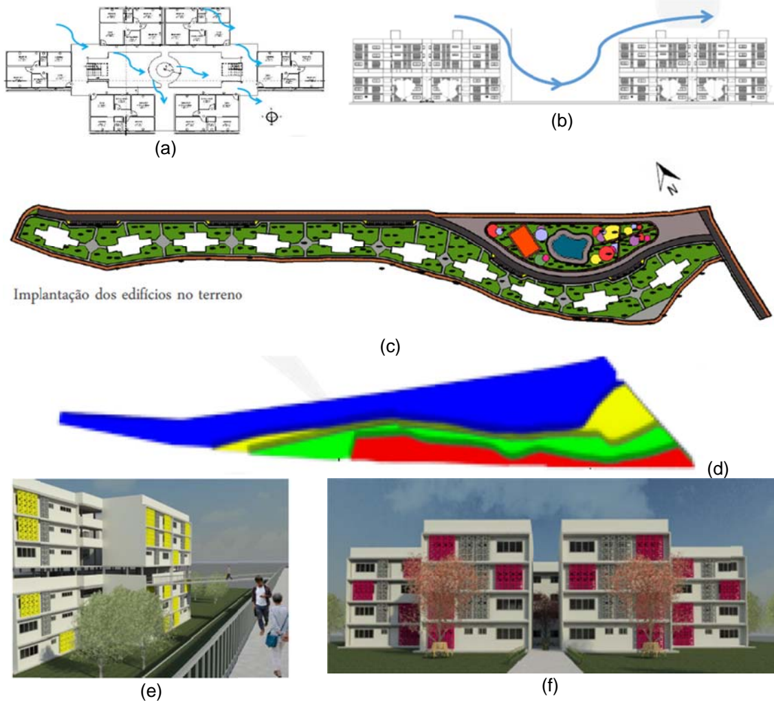
Figura 17: Implantação dos blocos (c) de acordo com os estudos de ventilação natural (a), espaçamento entre os blocos (b), zoneamento dos níveis do terreno (d), tipologia de 7 pavimentos (e) e de 4 pavimentos (f)
