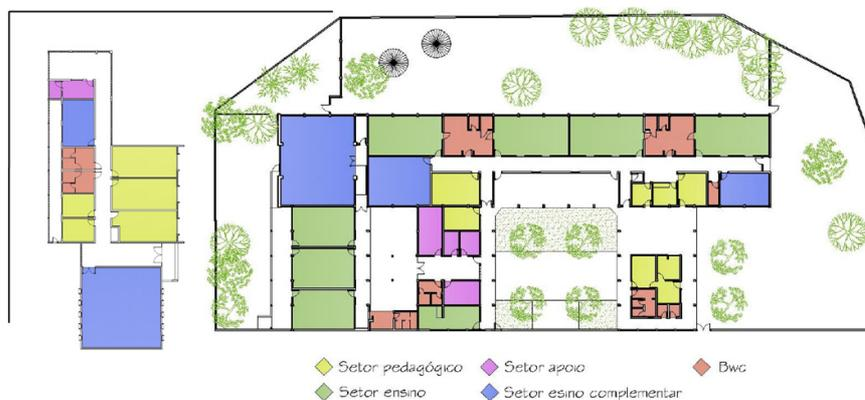
**Figura 3 - Planta baixa esquemática do NEI**
