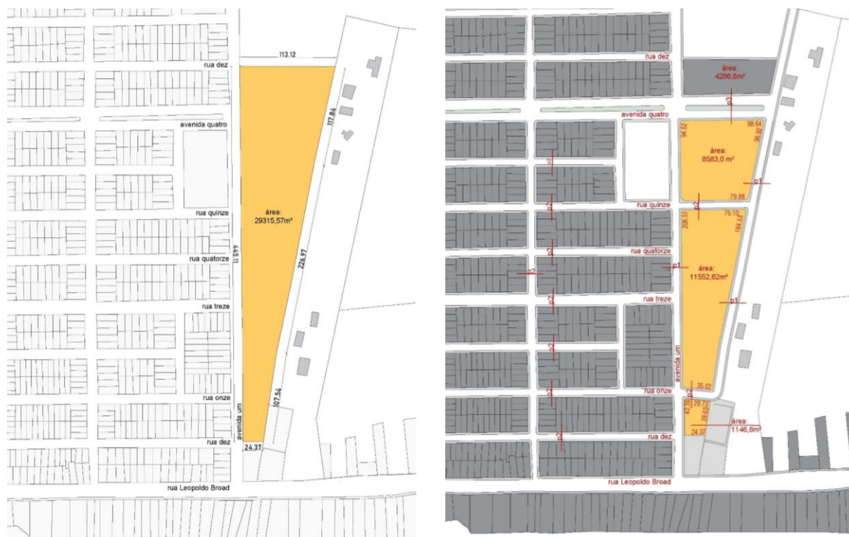
Figura 5. à esquerda situação original do loteamento Getúlio Vargas, à direita proposta de desenho urbano
