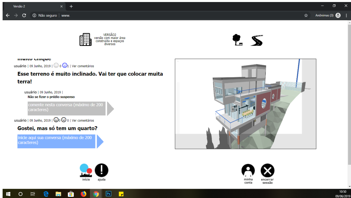
Figura 3 - Captura de tela da página de visualização do modelo e comentários. A janela da esquerda é um modelo tridimensional interativo, lido diretamente a partir do modelo IFC.
