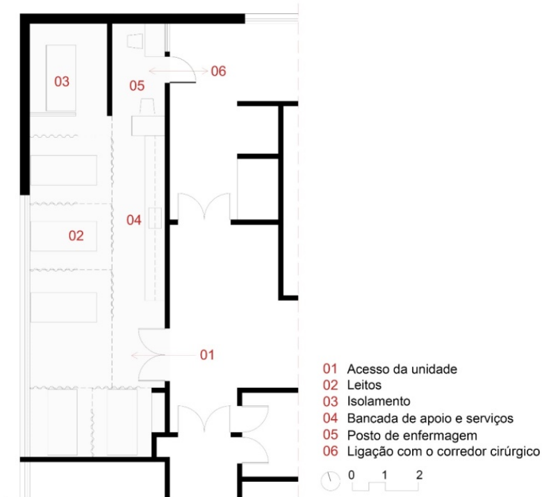
Figura 6: Planta da unidade de “assistência intensiva”
