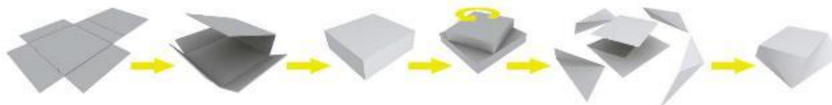
Figura 10 – Processo de construção da forma
