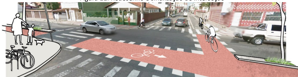
Figura 11: Redesenho e sinalização de interseção
