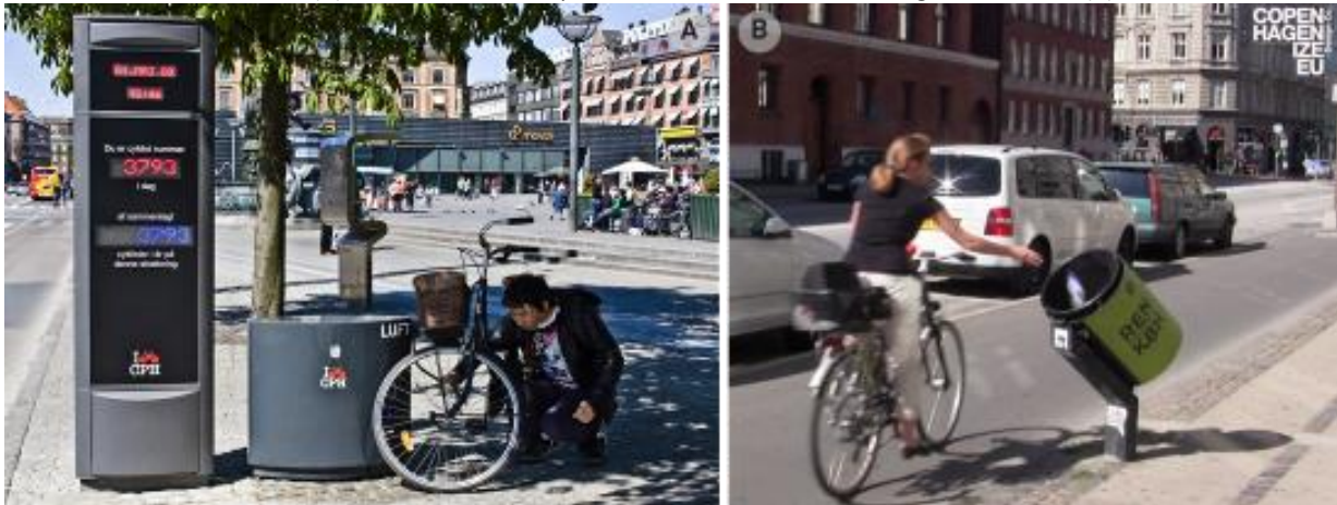
Figura 7: Contadores de quantos ciclistas passaram diariamente e anualmente, equipamento para encher o pneu das bicicletas (A) e lixeiras inclinadas para os ciclistas, instaladas ao longo das ciclovias (B).
