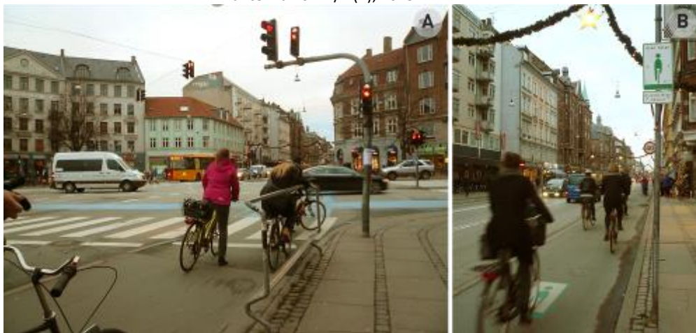
Figura 6: Cruzamento com faixas azuis pintadas para destacar o espaço dos ciclistas, semáforos específicos para carros e para ciclistas e barras de apoio (A). A onda verde é sinalizada de forma horizontal e vertical para avisar aos ciclistas que se mantém a 20 km/h (B), 2013.
