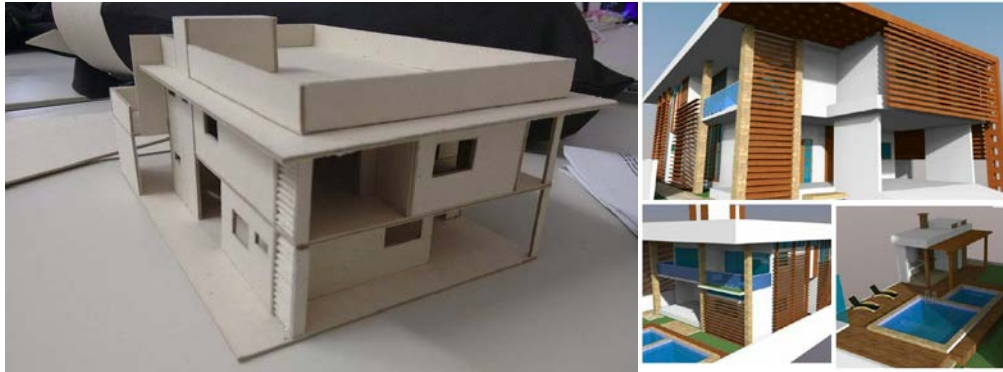
Figura 2: Maquete croqui integrada à computação gráfica para auxílio no processo de projeto.
