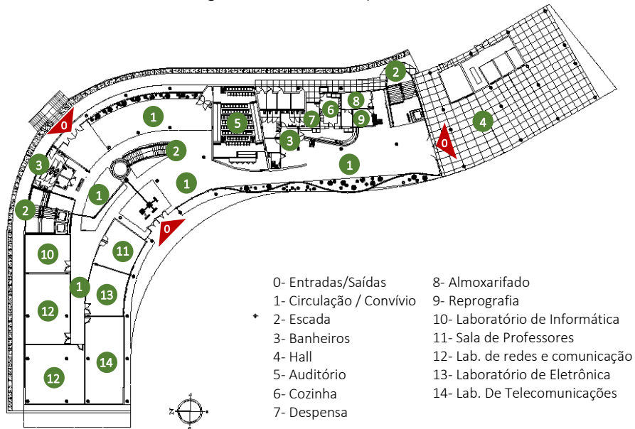
Figura 2: Planta baixa do pavimento térreo
