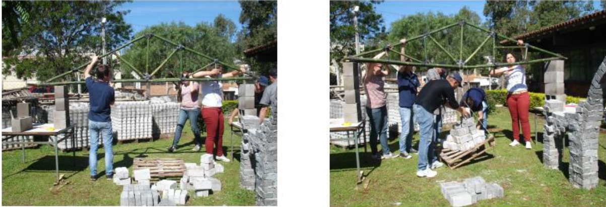
Figura 6: Treliça de bambu e teste de carga
