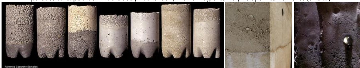
Figura 11: Provas de concreto para a aplicação na Capela do Irmão Claus, de Peter Zumthor (esquerda) e detalhes das paredes da Capela do Irmão Claus (Wachendorf, Alemanha), externa (meio) e internamente (direita).
