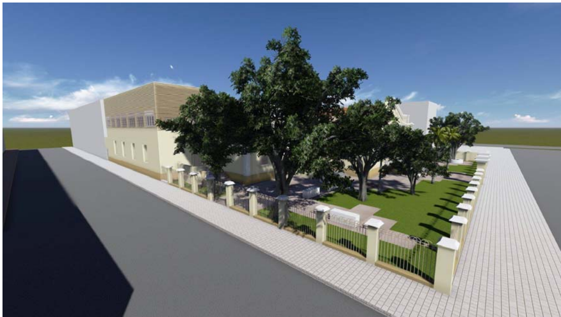
Figura 17: Imagem virtual da fachada lateral da edificação do Grupo Escolar Augusto Severo restaurada, destacando a recomposição de cheio e vazios do térreo e o tratamento diferenciado no primeiro pavimento.
